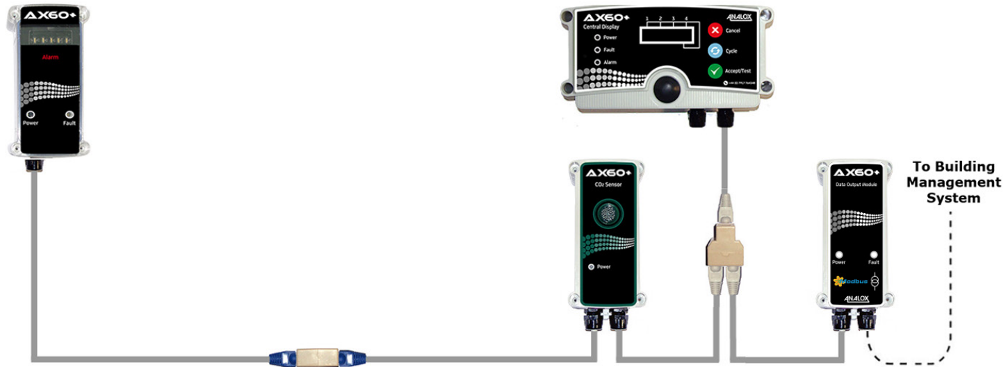
Beispielhaftes Layout eines Schnellanschlusssystems mit Datenausgabemodul
